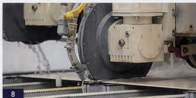
1.粉砕された磁器材との融合 2.サイロでの貯蔵 3.連続自動容器での分配 4.シート形成のためのプレス 5.調整と測定 6.窯での焼きなまし 7.焼き上がりのシート 8.マルチディスクでのシートカット 9.シートの補強
